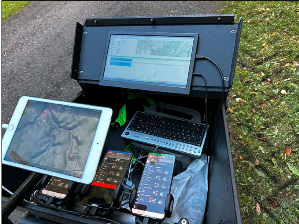
Messeequipment im Messfahrad (Scanner verdeckt unterhalb der Mobiltelefone)
